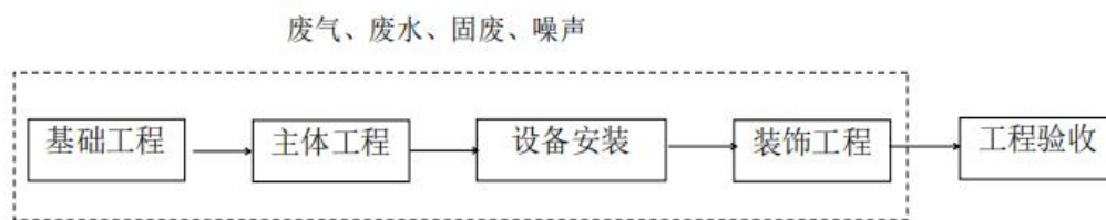
图 2-2 项目施工期工艺流程及排污节点图
